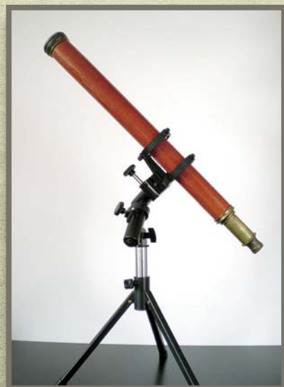
Телескоп-рефрактор-ахромат, изготовленный английским оптиком Чарльзом Вестом (Charles West) между 1806 и 1824 гг., установленный на ручной экваториальной монтировке Новосибирского приборостроительного завода (НПЗ)
