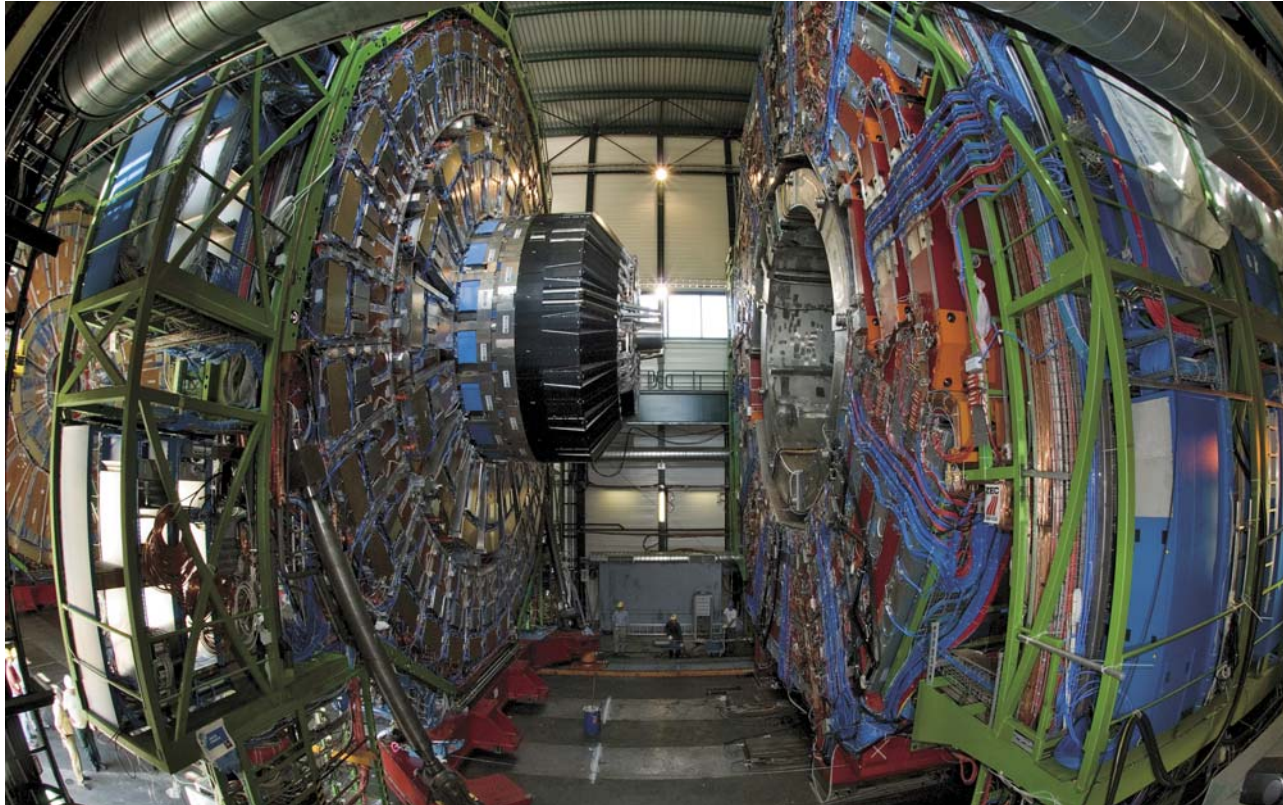
Детектор CMS (Compact Muon Solenoid – компактный мюонный соленоид) состоит из очень большого магнита, изготовленного из охлаждаемого жидким гелием сверхпроводящего материала, и детектирующих элементов различного типа. Предназначен для регистрации тяжелых частиц, рождающихся при столкновении протонных пучков
